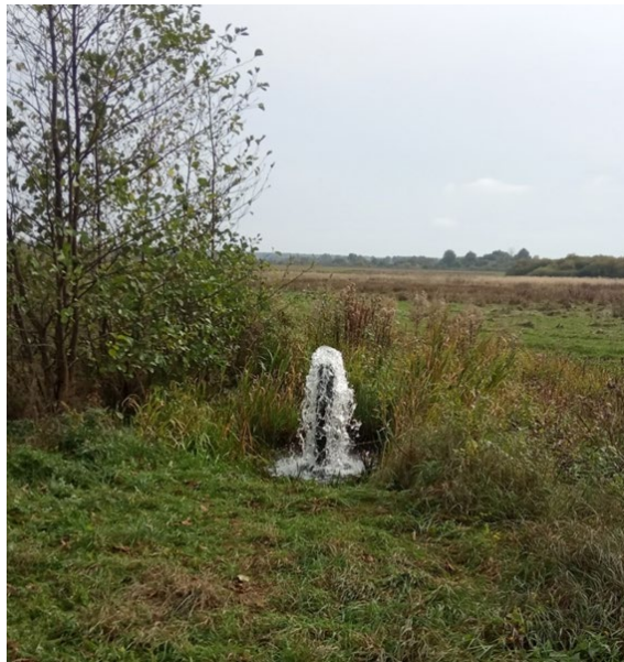
Рис. 1. Вигляд свердловини 156р, по якій вода здимається із горбашівського водоносного горизонту від глибини 110м. і виливається на заплаву р. Горинь поблизу с. Жалин Рівненського району
